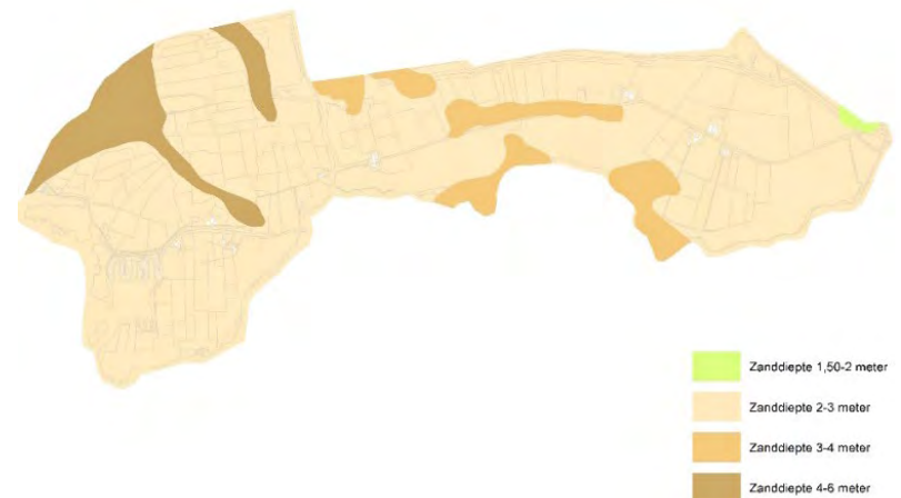
Afbeelding 2: De zanddieptekaart uit de jaren vijftig laat zien waar in het gebied je tot hoe diep moet boren voordat je op het zand terecht komt. Daarvoor moet je eerst door een flinke laag klei en veen.
